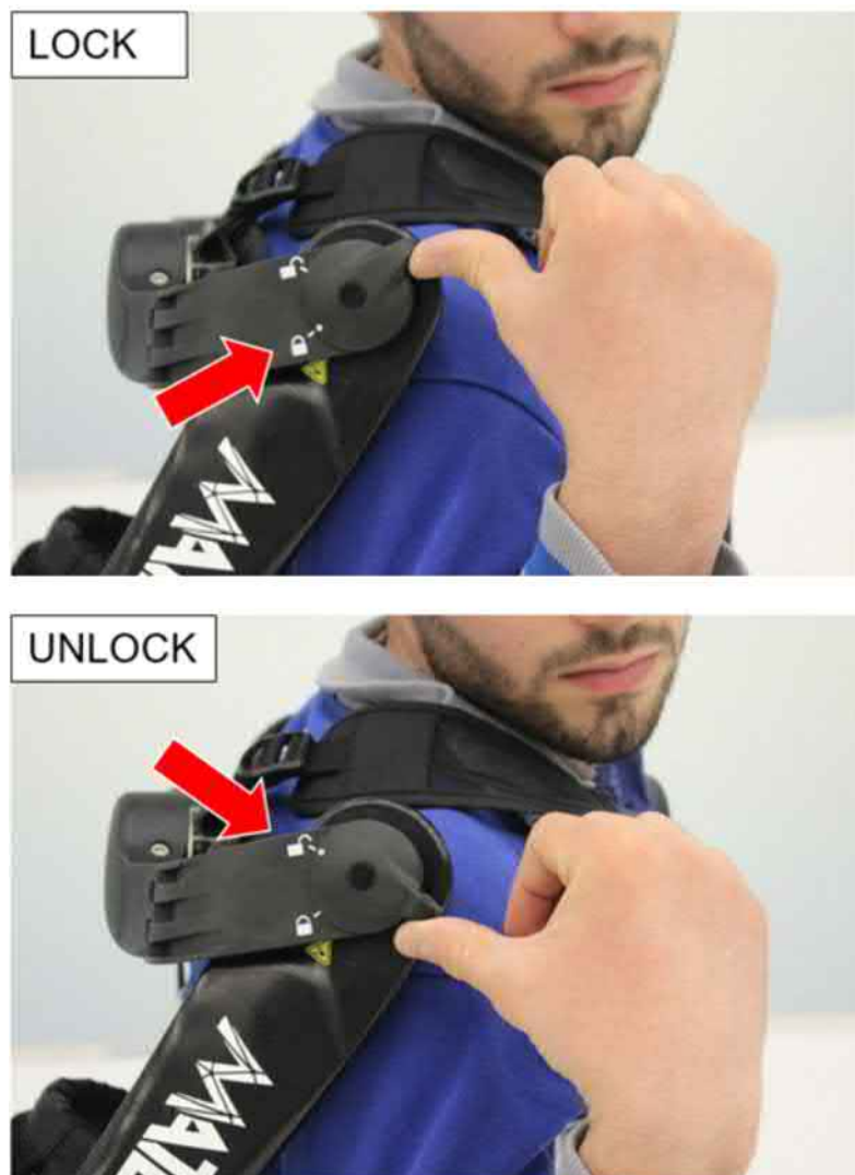
Fig. 3.6 - Boîtier générateur de couple : mécanisme de blocage
