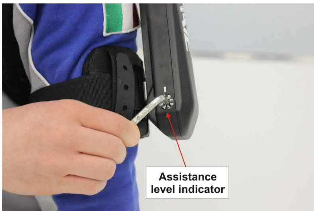
Fig. 4.3 - Vue rapprochée du siège du réglage du boîtier générateur de couple et de l'indicateur du niveau d'assistance
